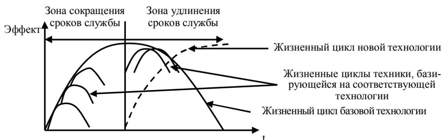
Рисунок 2 – Зоны принятия решений относительно сроков службы техники на различных стадиях жизненного цикла технологии
